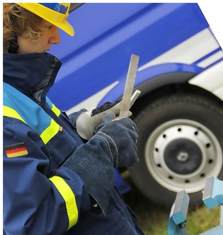
Lorenz Hertel beim Ablängen eines Gewindestabes: Nach dem Absägen mit einer Metallsäge muss der Stab mit einer Feile nachbearbeitet werden.
